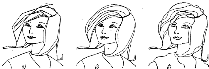
Рис. 5.2. Сплайны для таблично заданных неоднозначных функций: а) исходное задание (около 100 точек); б) гладкое восполнение (около 3000 точек); в) изменены вычисленные производные в точках соединения.
